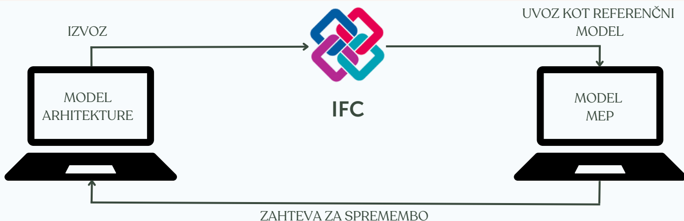
Slika 7: Delotok BIM z uporabo referenčnega modela v formatu IFC
