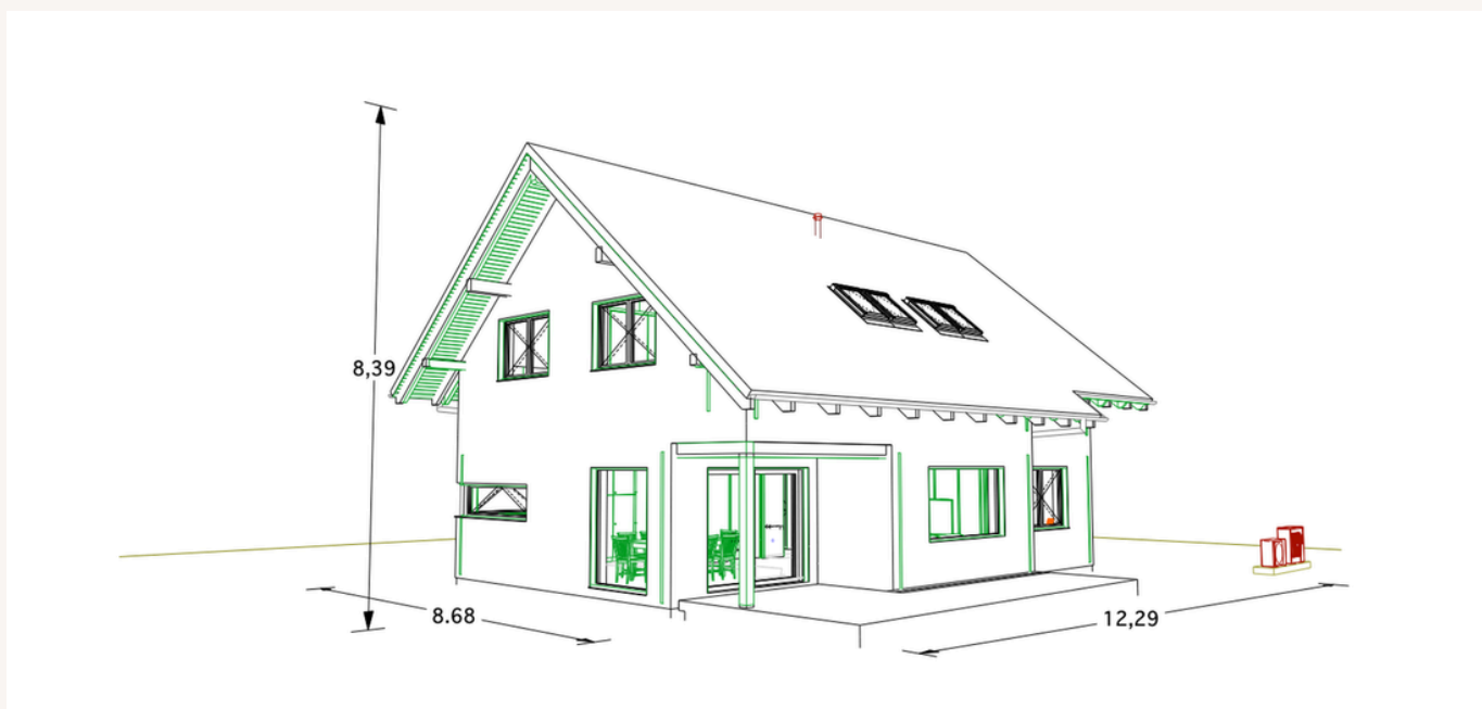
Slika 27: Dimenzije enostanovanjske stavbe PU1
